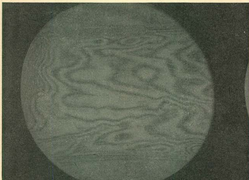
Fig. 7 Interferentie-patroon na borsteling met titaan-dioxyde 50 X
