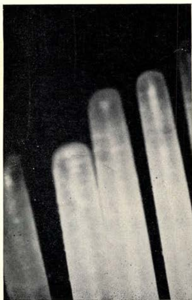
Fig. IIIe. Nylonborstel na 4 jaar dagelijks gebruik
