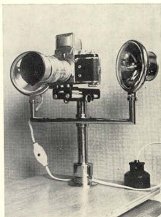
Fig. 4. De foto-installatie, thans aangevuld met Novoflex-instelslede voor accurate en snelle fijninstelling
