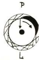
Fig. 3. Wigwerking van de rechte hevel en luxatie en rotatie van de radix door draaiing van de hevel
