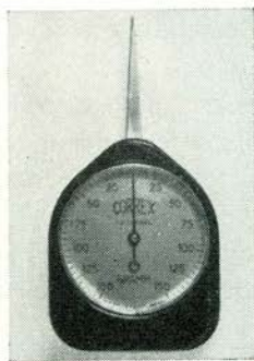
Afb. 1. Veerdrukmeter, apparaat voor het meten van krachten tot 150 gram.
