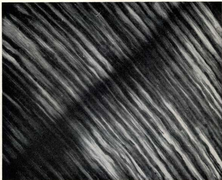
Afb. 11b. Opname in blauw licht van hetzelfde veld als in figuur 11a: op de plaats van de fluorescentie is nu de absorptie van de gele kleurstof in de lijn te zien.
