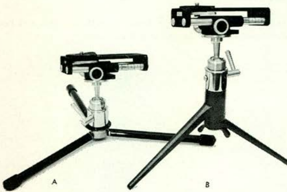
Afb. 10. (A) Oud statief waarvan de poten zijn ingekort. Zeer stabiel. (B) Normaal tafelstatief. Vaak niet erg stabiel.
