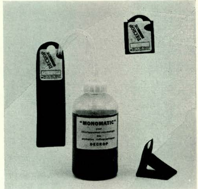
Afb. 1. De Decrop Monomatic X-Ray film en de manier waarop de film is verpakt. In het midden: de bijbehorende flacon met vloeistof. De canule is tot aan het merkteken, via de uitsparing, in het filmzakje gestoken. Met behulp van de perforatie kan het zakje tijdens het afwerken worden opgehangen.
