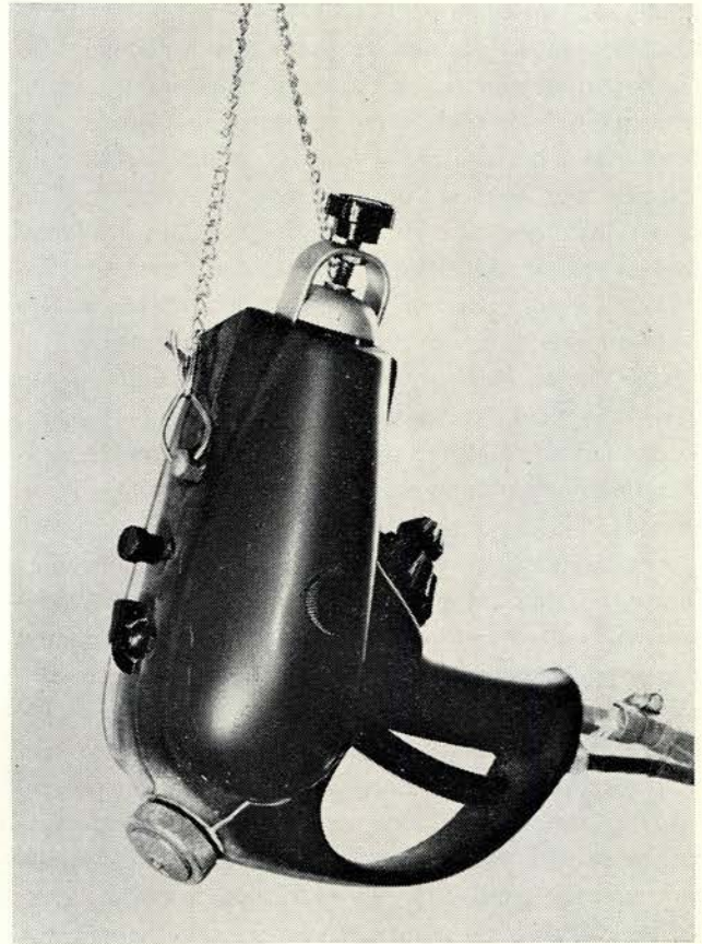
Afb. 2. De verstuiver voor het gesmolten metaal Cerrocact.
