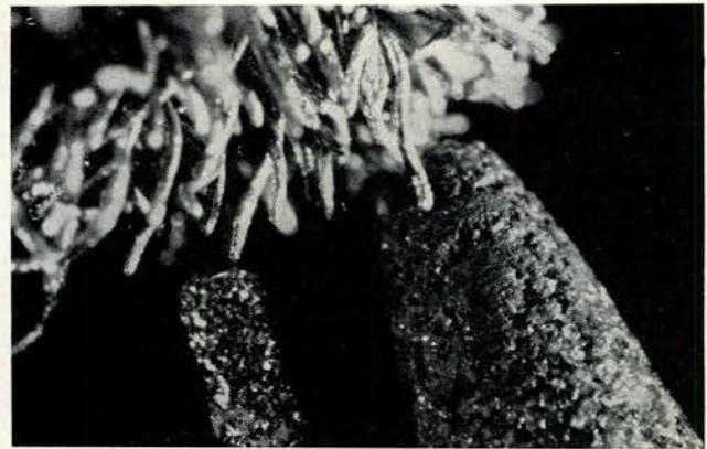
Afb. 1. De borstelharen van een koperborstel zijn te dik om de ruimten tussen de diamantpartikels te kunnen reinigen.
