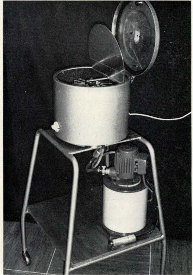
Afb. 1. Reinigungs- en smeerapparaat voor micromotor-aanzetstukken, bestaande uit een centrifuge met laadrek en een pomp die zorgt voor het rondpompen van een vloeistofstroom bestaande uit een olie verdund met een reinigingsmiddel.
