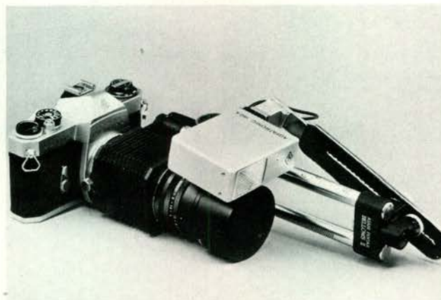
Afb. 6. Een bruikbare combinatie (geheel samengesteld uit standaard onderdelen) voor het maken van intra-orale fotografische opnamen.
