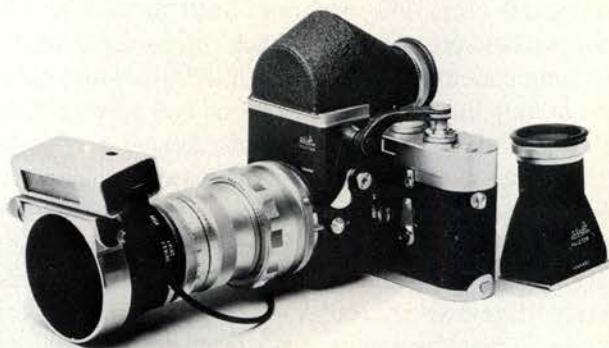
Afb. 1. Een ideale combinatie voor de intra-orale fotografie. Een Minox flits is met behulp van een speciale constructie, in alle richtingen wendbaar, op de zonnekap bevestigd.
