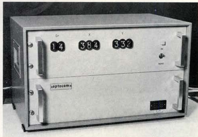
Afb. 3. De data-converter met afleesmogelijkheid.
