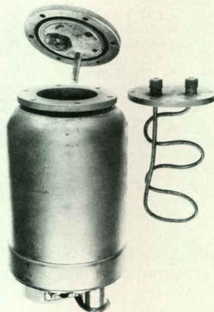
Afb. 2. Het boilerhuis (links) met uitgenomen de \pm 45 cm lange koperen buis (rechts). Door middel van deze constructie is de inhoud van de warmwatervoorziening van 600 ml teruggebracht tot \pm 6 ml.
