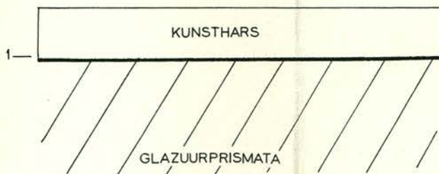
Afb. 2. Schematische voorstelling van een dwarsdoorsnede van niet geëts (runder) glazuur. De kunsthars penetreert niet in het glazuur. 1 = oorspronkelijk glazuuroppervlak.
