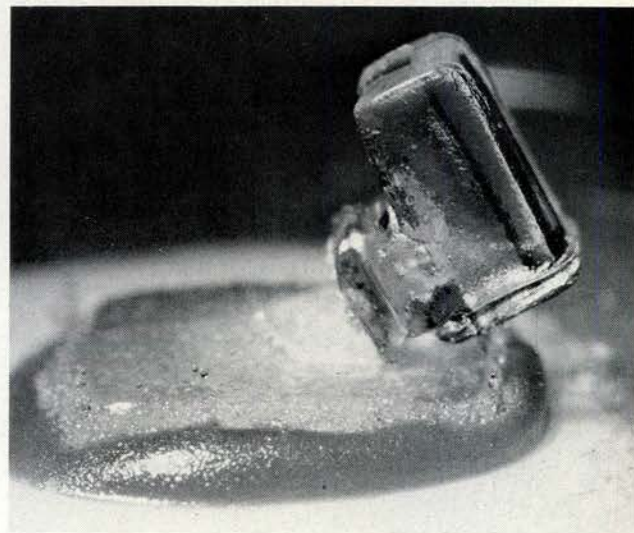
Afb. 4. Resultaat van een trekproef met een lightwire bracket. Vergroting 20 ×.
