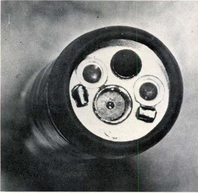
Afb. 2. Vooraanzicht van de fiberendoscoop met axiale optiek. Midden onder de lensopening; middenboven de opening van het biopsie (instrumenteer)- en afzuigkanaal.
