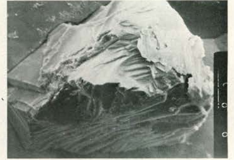
Afb. 8. Diamantkorrel na 40 seconden gebruik. Vergroting 460 \times .
