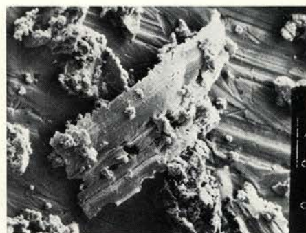
Afb. 11. Amalgaamspanen geproduceerd met diamantboor bij ca. 28 m/s omtreksnelheid. Vergroting 50 ×.
