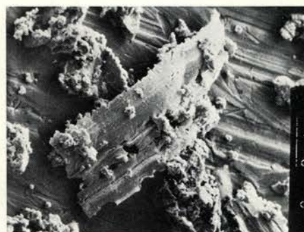
Afb. 11. Amalgaamspanen geproduceerd met diamantboor bij ca. 28 m/s omtrekssnelheid. Vergroting 50 ×.
