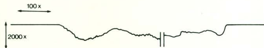
Afb. 2. Slijtageprofiel na poetsproef van 2000 borstelslagen.
