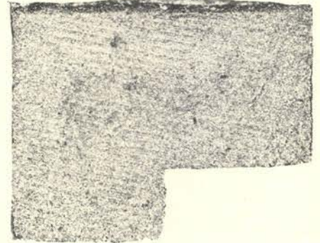
Afb. 2a. Voorbeeld van een in de proefcaviteit gecondenseerde amalgaamrestauratie die in de categorie II valt. De adaptatie aan de wanden is goed en het amalgaam is homogeen van samenstelling.
