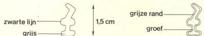
Afb. 3a. Een figuurtje zoals gegraveerd in de resopalplaat van afbeelding 2. De totale lengte van het figuurtje is 15 mm. Het smalste deel is 1,5 mm breed.
