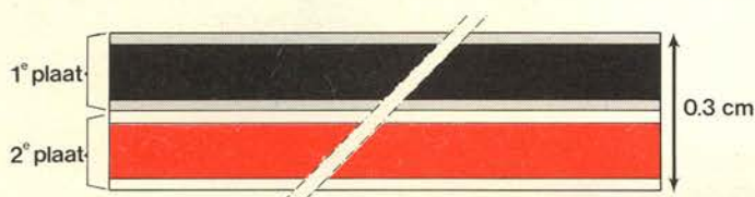
Afb. 1. Resopalplaat, samengesteld uit een tweetal in de handel zijnde platen, elk bestaande uit drie lagen van verschillende dikte en kleur.
