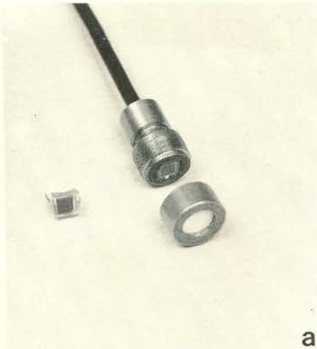
Afb. 1. Fotodiode (a) in een licht-dichte behuizing (Ø 10 mm) en (b) gemonteerd in een instel-apparaat (model Utrecht/Van Aken).
