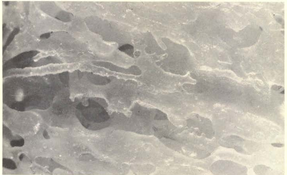
Afb. 4 Macrofotografische opname van poreus cement na uitwassen van de gel. Het porievolume bedraagt ca. 60%, de poriediameter 200-1000 \mu\text{m} .
