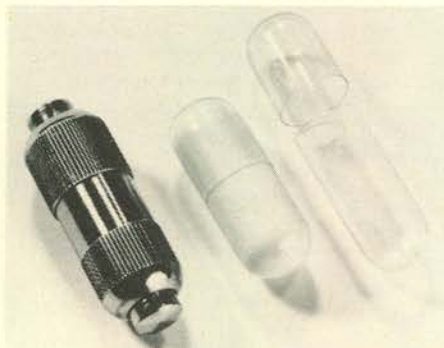
Afb. 3. De gelatine capsule (links), leeg en gevuld met kunstharspoeder (midden) en de metalen capsule (rechts).
