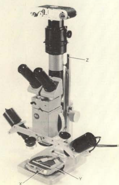
Afb. 6. Stereomicroscop met x-, y- en z-assen. Bovenop de microscoop het camerahuis.
