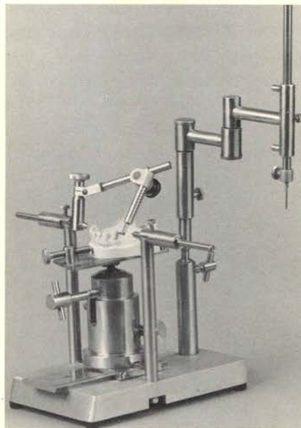
Afb. 17b. De rotatie-simulator met conventionele parallelometer of surveyor (model Korenhof en Staatsen).
