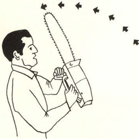
Afb. 1. Mechanisme van de 'kickback' in de richting van het gezicht.
