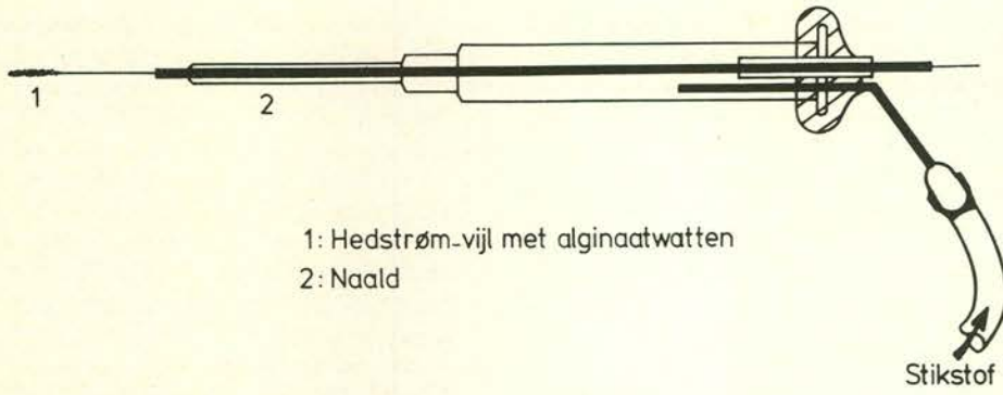
Afb. 2. Het instrument waarmee parodontale pockets en wortelkanalen anaëroob worden bemonsterd. 8
