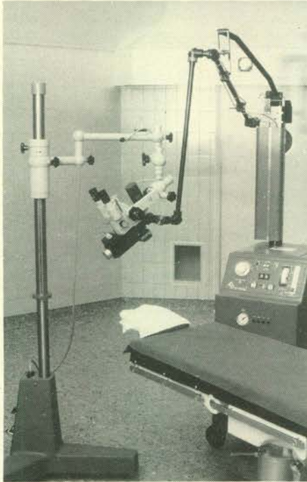
Afb. 6. Een opstelling van een CO 2 -laser met operatiemicroscop voor chirurgisch gebruik. De bundel laserlicht wordt via de spiegels in de gewrichten van het beweegbare buizensysteem naar de micromanipulator gevoerd.
