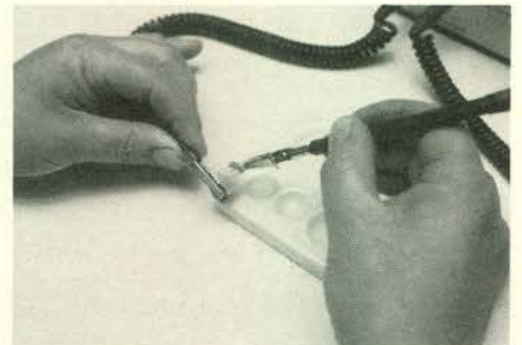
Afb. 2. Het vertinnen van een etsbrug. De O.V.S.-applicator bestaat uit een kathodeklem die op het gietstuk wordt gezet en een viltpuntanode geklemd in een pincet, waarmee de tin-vloeistof wordt opgebracht.
