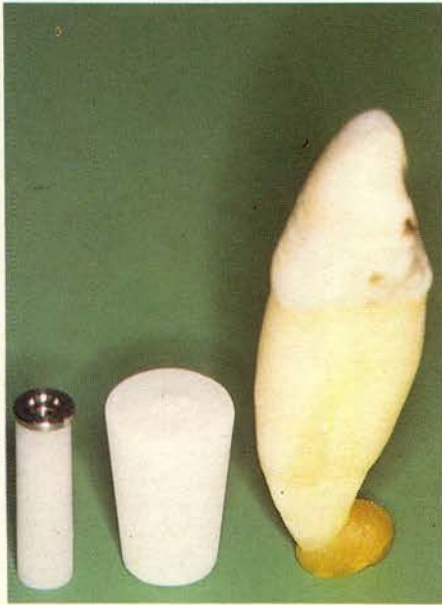
Afb. 1. Links het HA/TI-implantaat, in het midden het Bulk HA-implantaat en rechts een ondercuspidaat.
