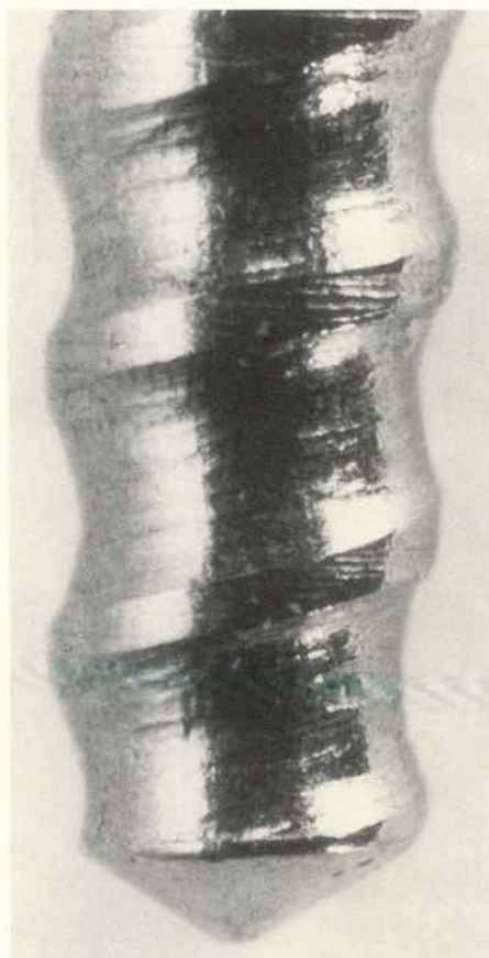
Afb. 1b. Oppervlaktestructuur van een wortelstift met schroefdraad. Vergroting 50 ×.
