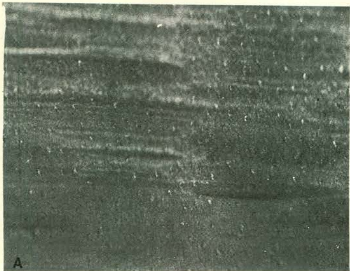
Afb. 3a. Dentine-oppervlak, verkregen met een gladde kanaalfrees. Tubulusopeningen zijn verstopt, en vaag zichtbaar in een dunne smeerlaag. Vergroting 500 \times .
