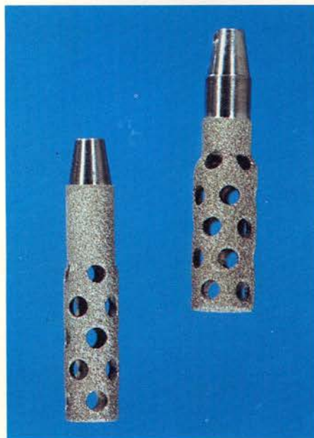
Afb. 1. Het holle cilinder titanium implantaat type F. Links: het oude model met een ruwe 'hals'; rechts: het nieuwe model, met een gedeeltelijk gladde 'hals'.
