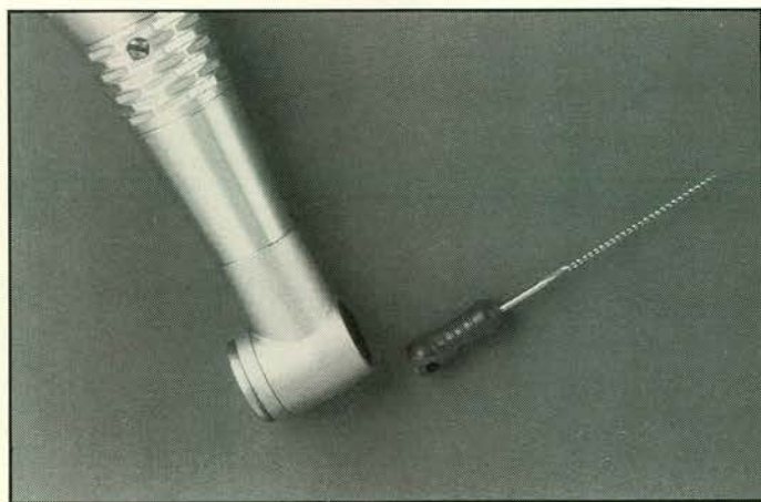
Afb. 5a. en b. Mechanisme waardoor het mogelijk is om gewone vijlen in een hoekstuk te gebruiken.
