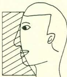
Afb. 2. Conventioneel gevormd filter (materiaal koper).
