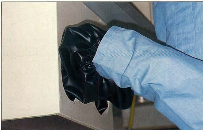
Afb. 1. Een zelfvervaardigde box voor het ontwikkelen van röntgenfoto's aan de stoel.
