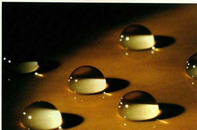
Afb. 3 en 4. Voorbeelden van verschillende contacthoeken. De vloeistof op afbeelding 3 heeft een kleinere contacthoek en een betere bevochtiging dan de vloeistof op afbeelding 4.
