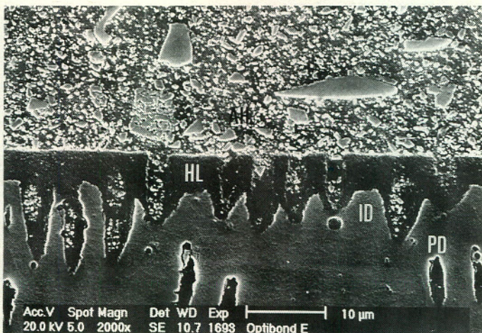
Afb. 7. SEM-opname van de hars-dentinehechting verkregen met Optibond®. Het dentine werd geëtsd met een 37% fosforzuurgel gedurende 15 seconden. Een hybride laag (HL) van ongeveer 5 µm is zichtbaar ter hoogte van het intertubulair dentine (IS) en is bedekt met een adhesief hars (AH), gevuld met natrium-fluoridesilicaat en barium-glaspartikels. De dentinekanaaltjes zijn aanzienlijk door de forforzuurconditionering verwijderd en door een harsuitloper (HU) verzegeld. PD = peritubulair dentine.
