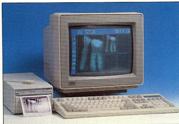
Afb. 1. Voorbeeld van een systeem voor het maken van digitale röntgenopnamen. Het beeld dat op de Sensor wordt opgevangen, wordt direct in de computer ingevoerd.
