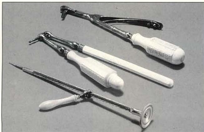
Afb. 1. Drie typen handboren uit het midden van de negentiende eeuw.
