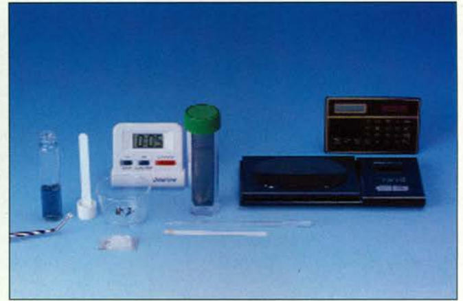
Afb. 2. Benodigdheden voor de speekseltesten 7 t/m 9: paraffine, proefbeker, keukenwekker, weegschaal, rekenmachine, dentobuff strip, spatel en houders voor testen op micro-organismen.
