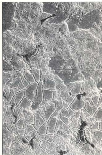
Afb. 1. Het metaal van de palatinale cervicale rand is bedekt met plaque. De enkele poriën die zichtbaar zijn, staan in open verbinding met de mond en vormen daardoor een galvanisch (zuurstof-)element waardoor metaalionen worden afgegeven. Deze kunnen door patiënten worden geproefd. (M = 0,1 mm).
