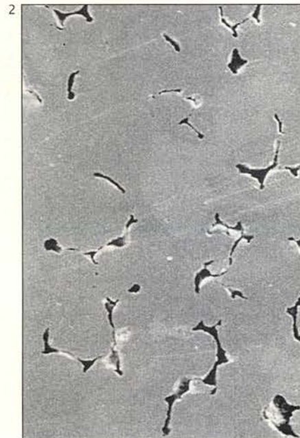
Afb. 1. Het metaal van de palatinale cervicale rand is bedekt met plaque. De enkele poriën die zichtbaar zijn, staan in open verbinding met de mond en vormen daardoor een galvanisch (zuurstof-)element waardoor metaalionen worden afgegeven. Deze kunnen door patiënten worden geproefd. (M = 0,1 mm).
