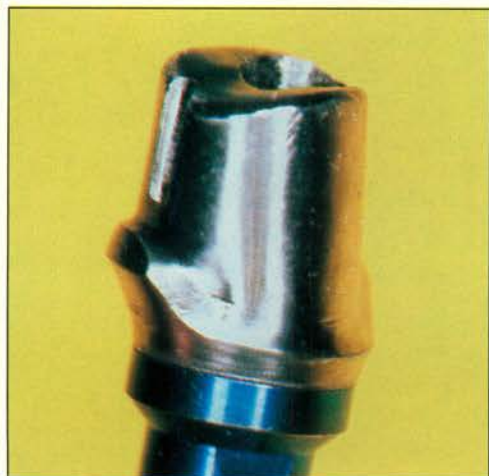
Afb. 3. Met opwassen en aangieten zijn abutments in diverse vormen te maken, in dit geval voor een premolaar.
