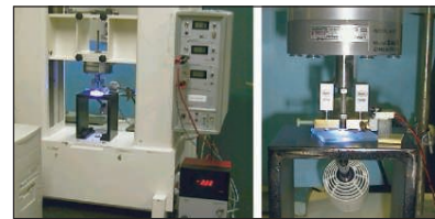
Een proefopstelling van een in eigen beheer vervaardigde tensiometer om de vormveranderingen van een lichthardende composiet te meten.
